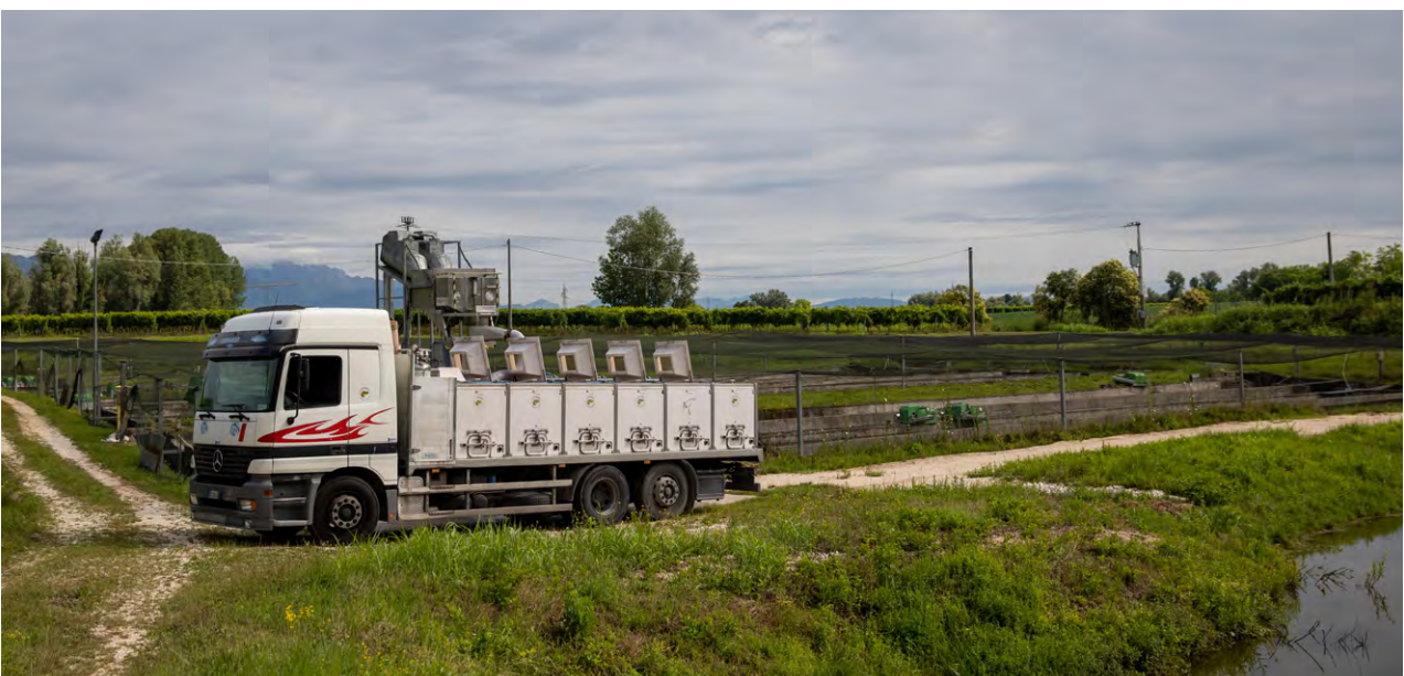
Particolare dei contenitori di carico e relative aperture superiori per il carico e l'ispezione
